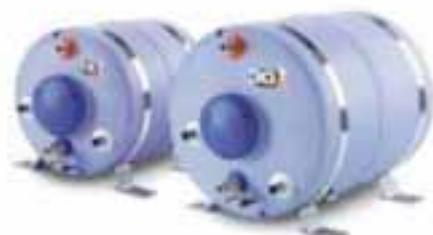
Revêtement en composite garantit une haute résistance aux chocs et à la corrosion marine Il facilite l'installation. L'épaisseur du réservoir est de 1,5 mm en acier inox AISI 316 La résistance électrique est faite d'acier résistant à la corrosion galvanique. Echangeur de chaleur a large surface.
