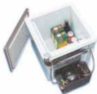
Offrant des températures allant de +5°C à -10°C, il peut être utilisé en réfrigération ou en conservation. Les parois latérales sont en acier inoxydable et le fond en plastique. Il est équipé d'un compresseur ventilé pouvant être monté déporter jusqu'à 1,5 m et d'un panier pour optimiser le stockage.
