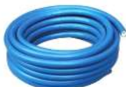
Tuyau eau chaude PVC Tuyau résistant aux agents détergents et désinfectants tout en étant de qualité alimentaire. Un revêtement extérieur bleu non tachant, résistant aux produits gras. Température de -15 à +100°C. Pression max de service 15 bars à 100°C. Réf : AR14976 Ø INT 19mm, Ø ext 28mm, Ø courbure 115m
