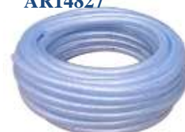
Tuyau souple toutes utilisations Tuyau incolore transparent tout usages, en PVC qualité alimentaire renforcé par une tresse. Supporte de -5°C à +60°C. Pression de service à 20°C. Applications : transport de l'eau, des huiles, distribution d'air comprimé à basse pression... Réf : AR14888 Ø int 19mm, Ø ext 26mm pression service 15b Réf : AR14889 Ø int 25mm, Ø ext 33mm pression service 13b Réf : AR14890 Ø int 38mm, Ø ext 48mm, pression service 8b Longueur : 25m
