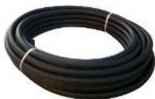
Tuyau eau chaude EPDM Tuyau de refoulement, supportant une température de -35 à +100°C. Armature plis textile. Pression de travail 10 bars. Compatible eau glycolée (chauffage, climatisation). Réf : AR14703 ØINT 12mm Ø ext 19 mm, Ø courbure 130 mm Longueur : 20m
